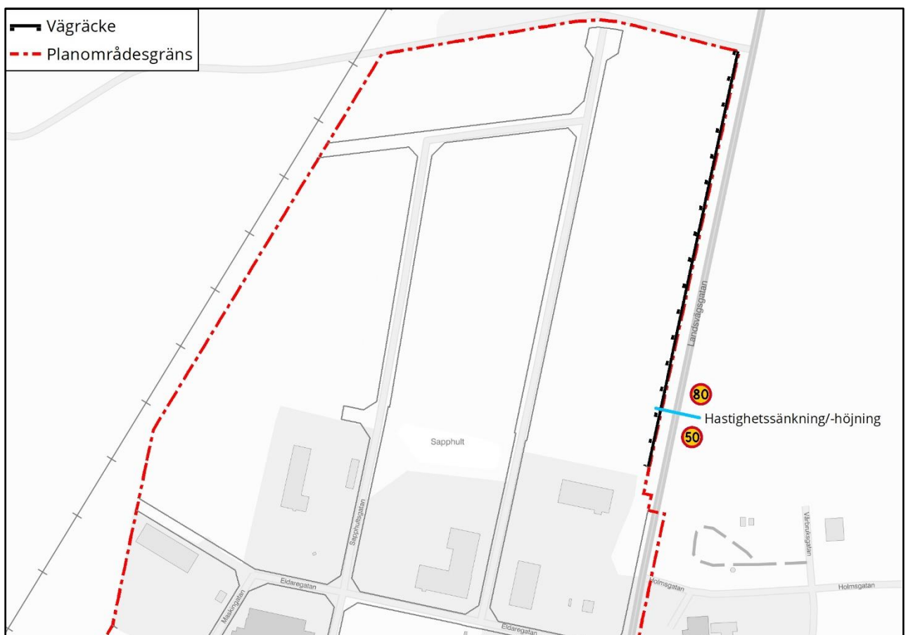
Ungefärlig placering av nytt vägräcke, cirka 340 meter
