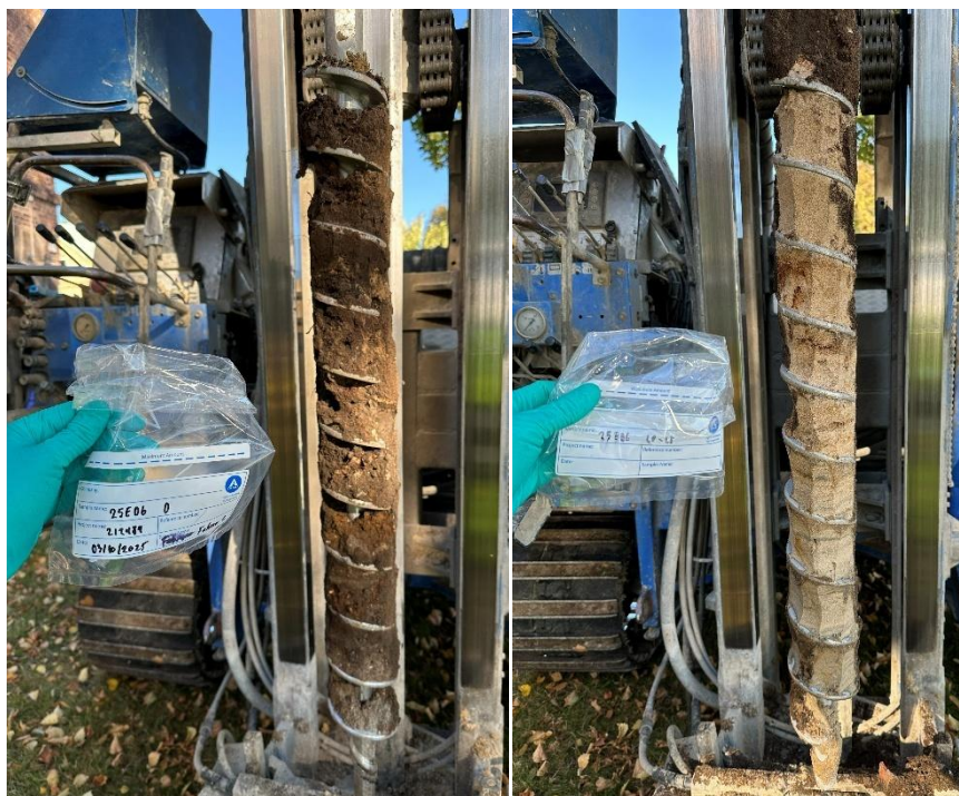
Figur 7. Borrkärna för punkt 25E06. 0 - 1 meter till vänster. 1 - 2 meter till höger.
