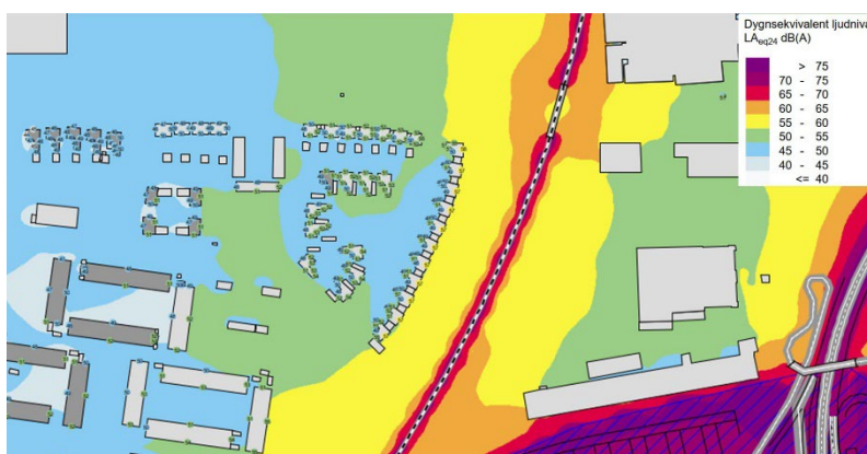
Ekvivalent ljudnivå från spårtrafik och östra ringvägen, utklipp från Swecos rapport (Sweco, 2023-12-04)
