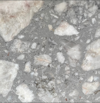
↑ Terrazzogolv och fönsterbänkar
