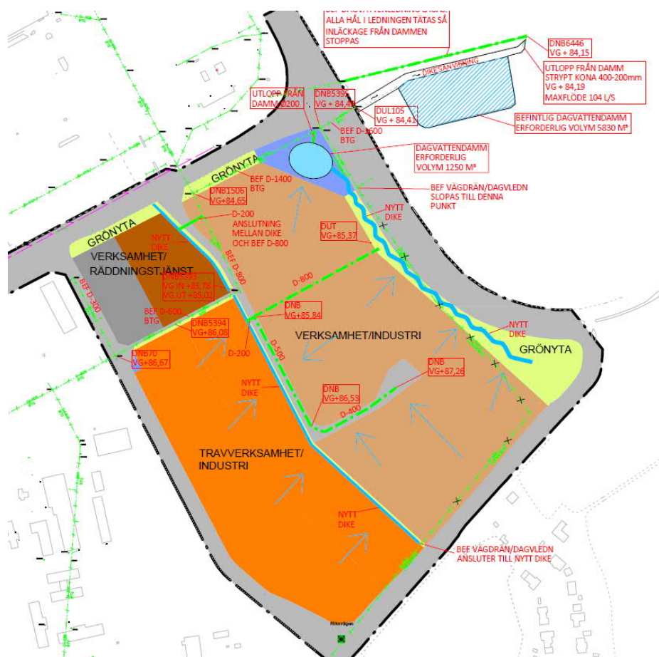
Figur 3. Från Rambölls dagvattenutredning, förprojektering 2020-07-10.
