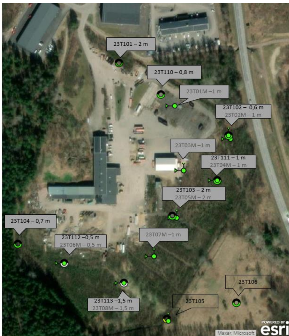
Figur 5 Karta över borrhälsarna. Fyllning har påträffats i de gråmarkerade rutorna och fyllningens maktighet anges i meter. Miljöpunkterna namngivna i ljusgrå text.
