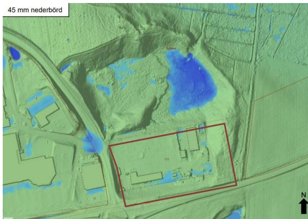
Simulering av 45 mm regn (100-årsregn med 30 min varaktighet) i Scalgo Live (2021). Ungefärligt planområde är markerat i rött.
