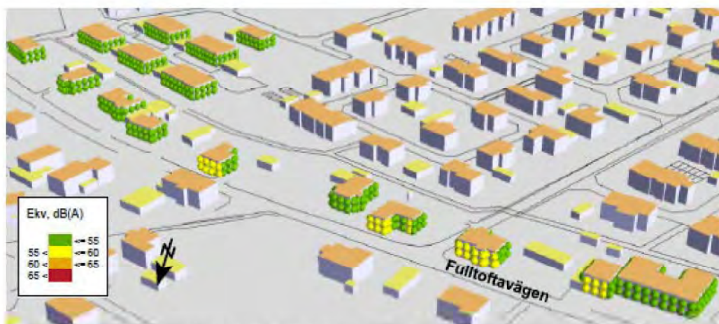
Ekvivalenta ljudnivåer vid fasad på befintliga bostäder, sett från norr (Trivector 2018).
