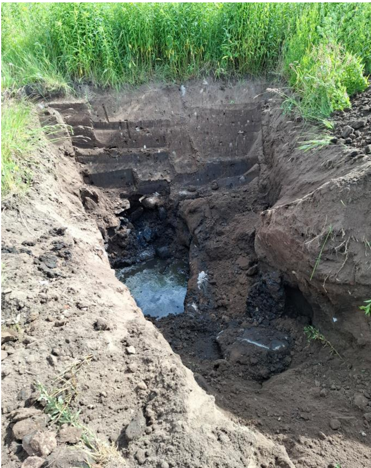
Figur 5 AV2511. Brun fyll till 2,2 m. Under 2,2 m kom svart stenig fyll med betongblock och armering. Vatten från ca 2,4 m. Gick inte att gräva till naturlig jord.
