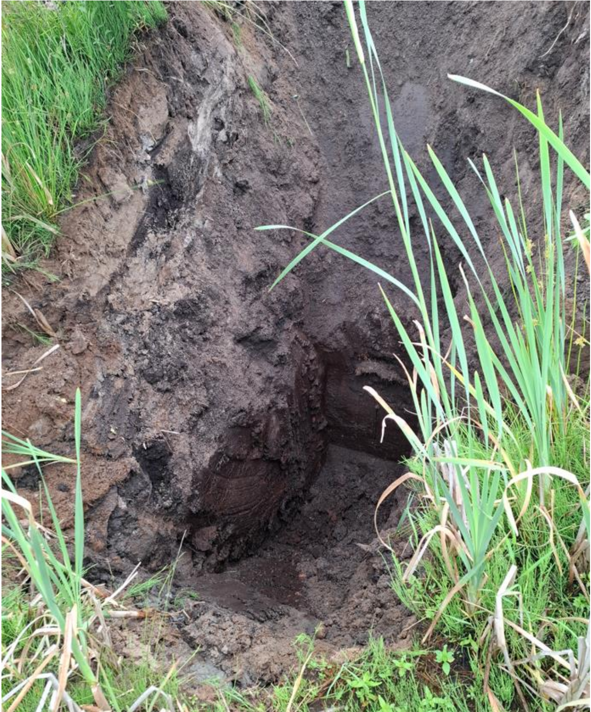
Figur 6 AV2502. Fyllnadsmassor av sand och sten till 0,8 m. Brun torv ligger under sanden.
