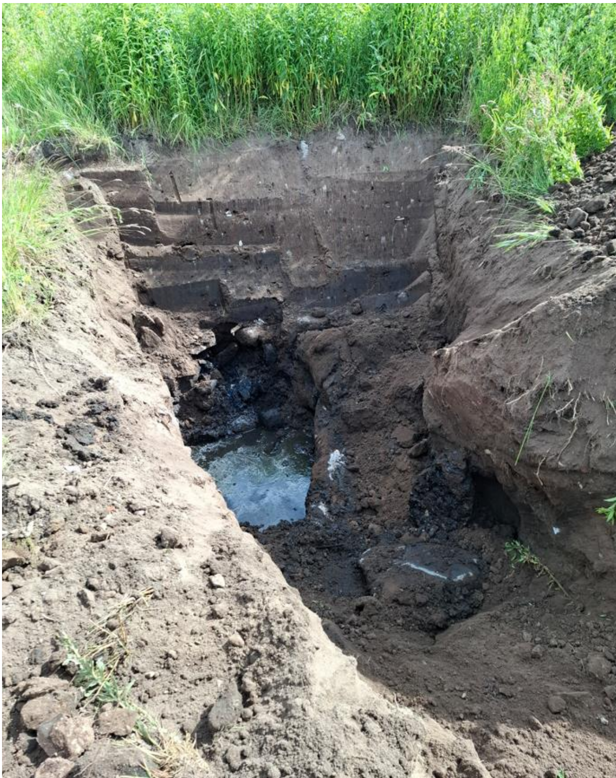
Figur 15 AV2511. Brun fyll till 2,2 m. Under 2,2 m kom svart stenig fyll med betongblock och armering. Vatten från ca 2,4 m. Gick inte att gräva till naturlig jord.
