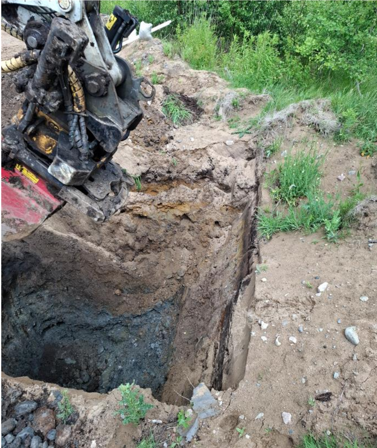
Figur 13 AV2509. Naturlig sand och grus från 0,4 m. Isälvsmaterial. Grå och blöt från ca 1,5 m.
