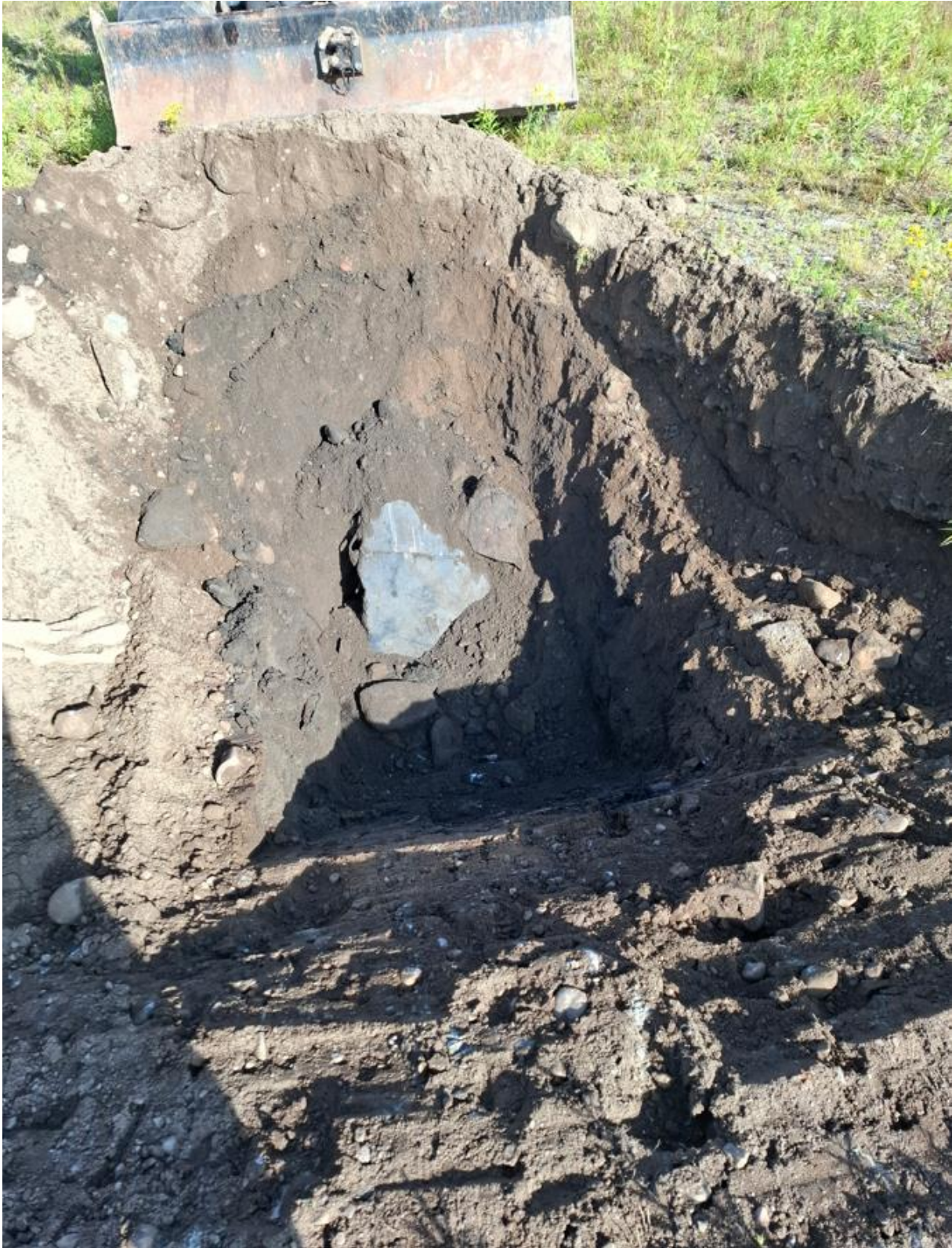
Figur 14 AV2510. Mörk fyll med sand, sten, betong och tegel till 3,4 m.
