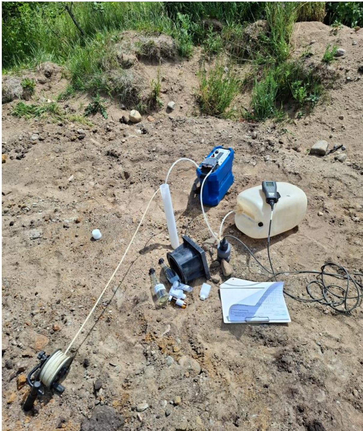
Figur 3 Vattenprovtagning och omsättning med peristaltisk pump i AV2509. Fältmätning med instrument YSI ProPlus genom flödescell.
