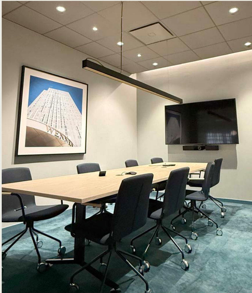
Pendlat undertak och bärverk kant A T15 i kulör varmgrå
