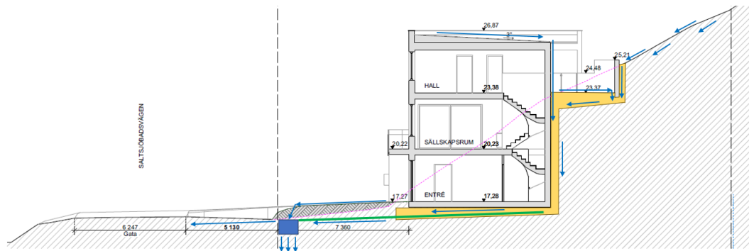
Figur 9. Schematisk skiss över hur vattnet är tänkt att avrinna till den östra stenkistan. Gul polygon = poröst material mellan fast berg och fasad. Grön linje = husdränering. Blå polygon = östra stenkistan. Blåa pilar= rinnvägar. Ritning av Bostadsutvecklaren i Sverige AB, 2026-06-11, modifierad av WRS.
