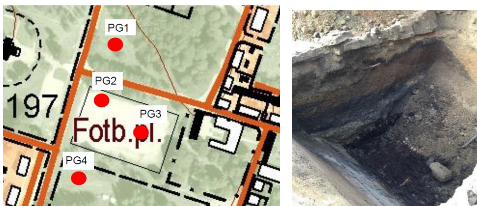
Figur 6, Vänstra bilden lokalisering PG1-PG4, Högra bilden, PG2 med avgrävd kabel
