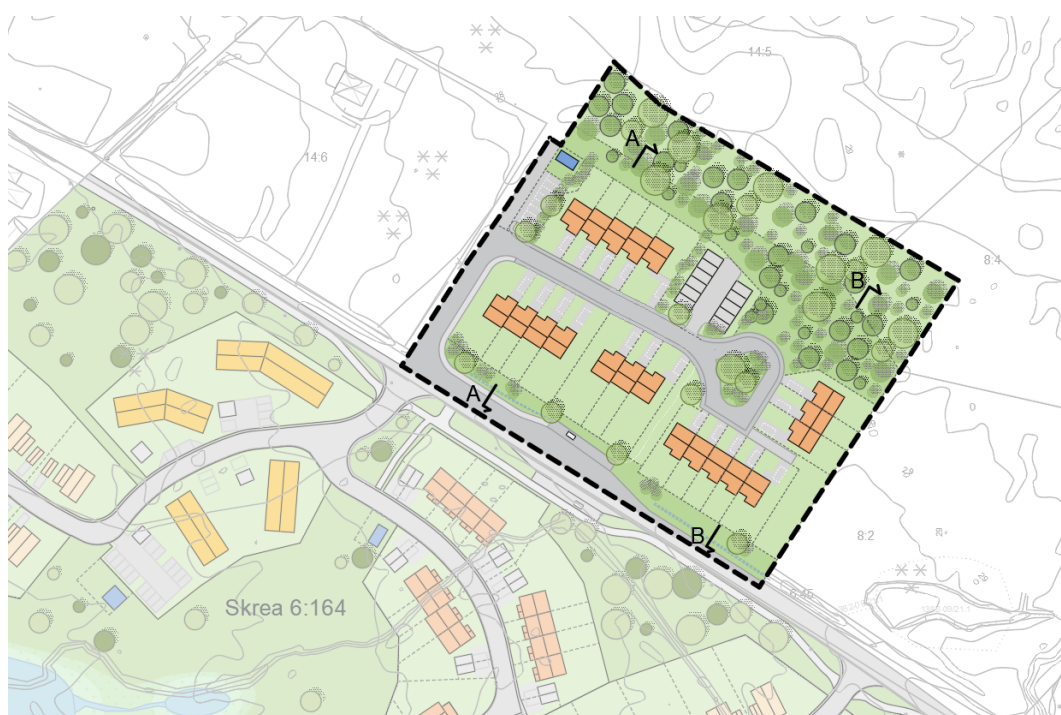
Figur 8: Illustrationsplan som visar planförslaget tillsammans med planerad bebyggelse i detaljplan för Skrea 6:164. Planområdet för Skrea 29:1 är markerat med svart streckad linje. Andra byggnadsförslag är möjliga. Blå ruta illustrerar nätstation och grå rutor illustrerar garage.
