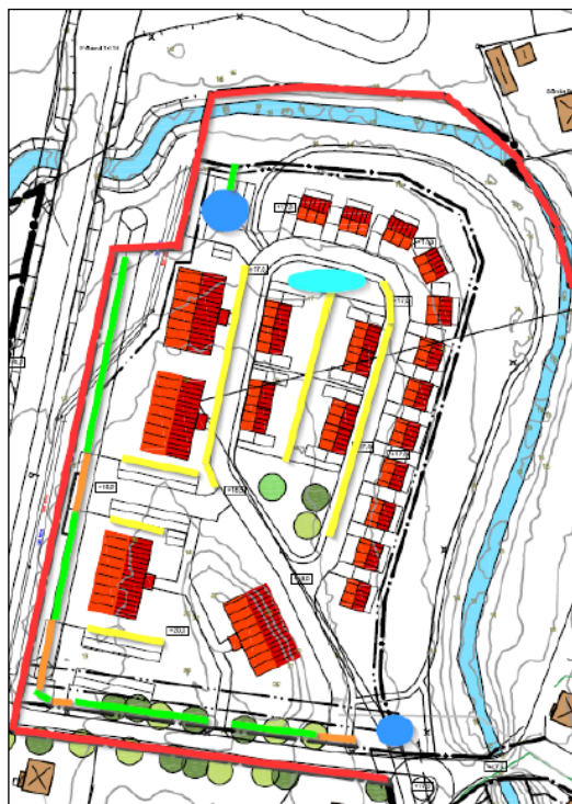
Figur 40: Föreslag på dagvattenhantering för nytt bostadsområde 4 från dagvattenutredningen. Grön linje är fördröjningsdike, orange linje är trumma, gul linje är krossdike, blå cirkel är dagvattendamm och ljusblå cirkel är LOD-damm.
