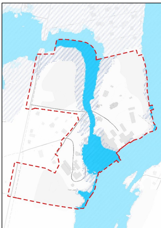
Figur 18: MSB:s översvämningskartering inför samråd med aktuellt planområde i rött. 100- och 200 årsflöde sammanfaller till stora delar och det kan därav vara svårt att se skillnad på dessa.
