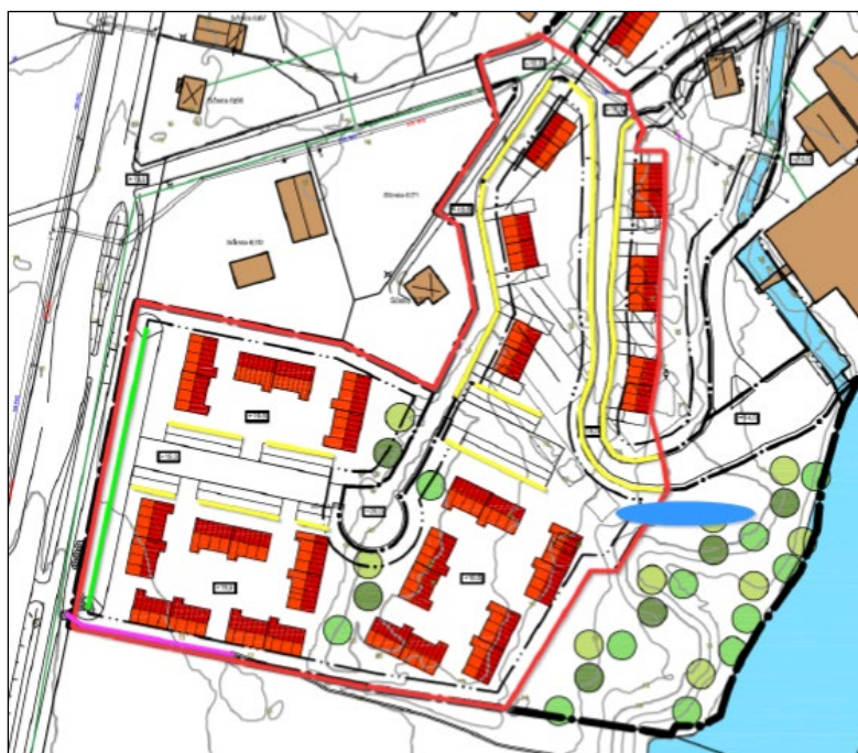
Figur 39: Förslag på dagvattenhantering för nytt bebyggelseområde 2 och 3 enligt dagvattenutredningen. Rosa linje är avskärningsdike, gul linje är krossdike, grön linje är fördörningsdike och blå cirkel är dagvattendamm. OBS figuren är från samrådsförslaget vilket medför att avvikelser i förslaget kan förekomma. Dagvattensituationen bedöms dock likvärdig.
