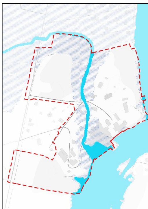
Figur 19: MSB:s uppdaterade översvämningskarta med aktuellt planområde för granskning i rött. 100- och 200 årsflöde sammanfaller till stora delar och det kan därav vara svårt att se skillnad på dessa.
