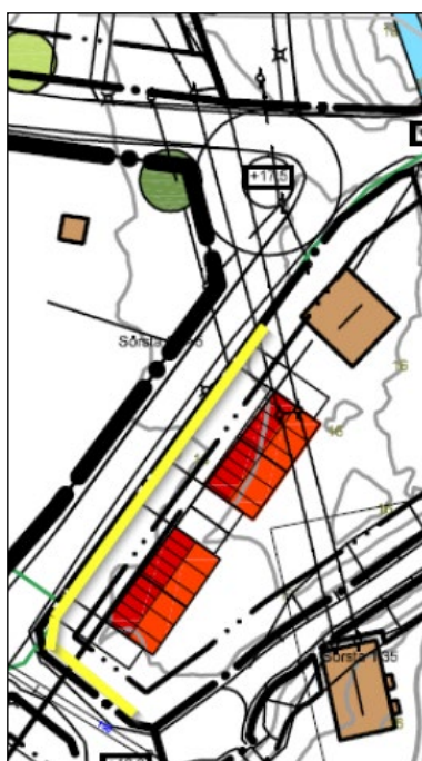
Figur 38: Förslag på dagvattenhantering för nytt bostadsområde 1 från dagvattenutredningen. Gul linje är krossdike. OBS figuren är från samrådsförslaget vilket medför att avvikelser i förslaget kan förekomma. Dagvattensituationen bedöms dock likvärdig.
